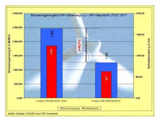
Abb. 18: Stromertragsvergleich V90-2MW/NH105m - V80-2MW/NH67m (Referenz-WEA)
