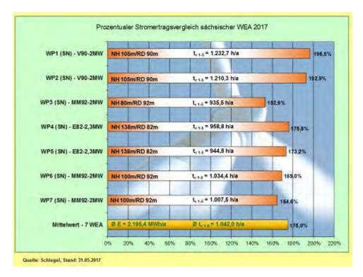
Abb. 25: Stromerträge-Vergleich - prozentual und nach Volllaststunden (Mai)
