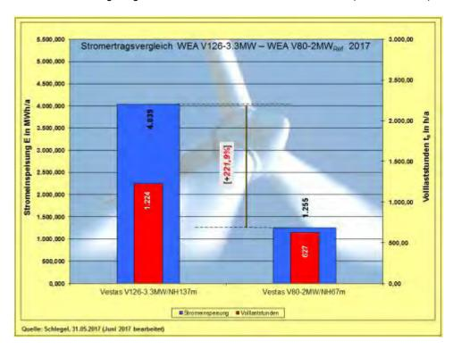
Abb. 20: Stromertragsvergleich WEA-3MW-Klasse - V80-2MW/NH67m (Referenz-WEA)
