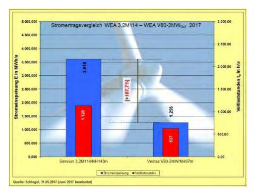
Abb. 19: Stromertragsvergleich WEA-3MW-Klasse - V80-2MW/NH67m (Referenz-WEA)
