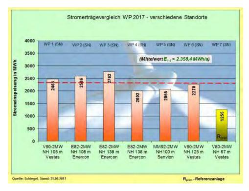
Abb. 22: Stromerträge-Vergleich von WEA im Sachsenquerschnitt (Mai)
