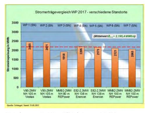
Abb. 24: Stromerträge-Vergleich von WEA im Sachsenquerschnitt (Mai)
