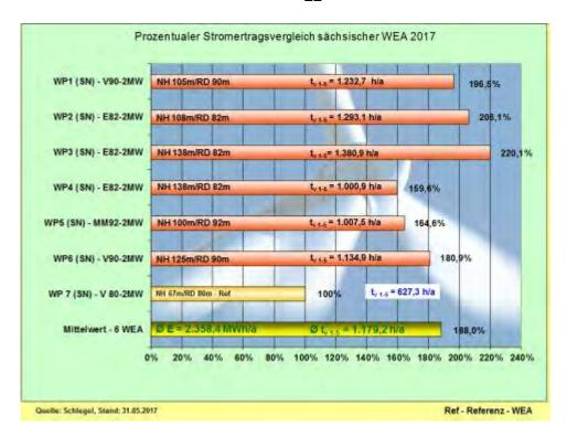
Abb. 23: Stromerträge-Vergleich - prozentual und nach Volllaststunden (Mai)
