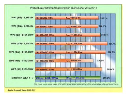
Abb. 29: Stromerträge-Vergleich 3MW-Klasse - prozentual und nach Volllaststunden (Mai)
