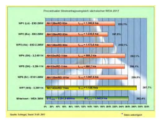
Abb. 27: Stromerträge-Vergleich - prozentual und nach Volllaststunden (Mai)
