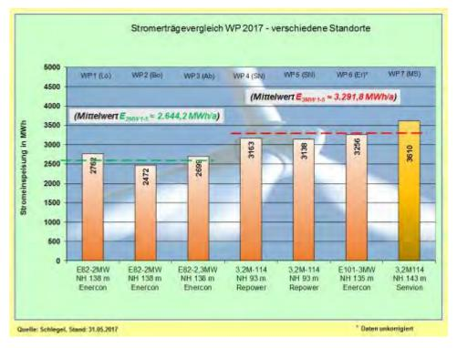
Abb. 26: Stromerträge-Vergleich – 2MW-Klasse mit 3MW-Klasse (Mai)
