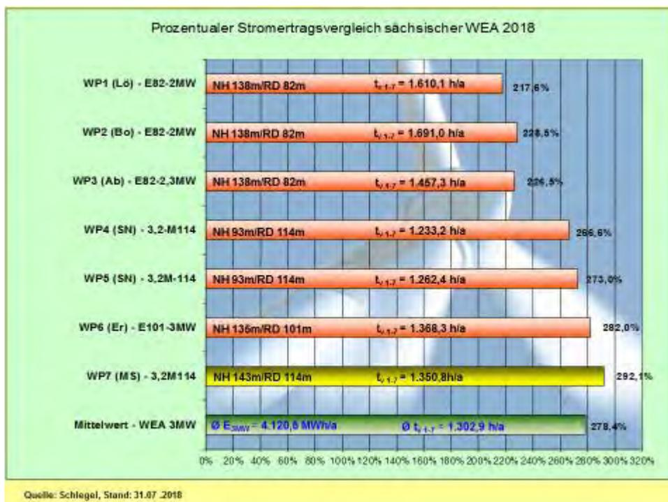
Abb. 36: Stromerträge-Vergleich - prozentual und nach Volllaststunden (Juli)
