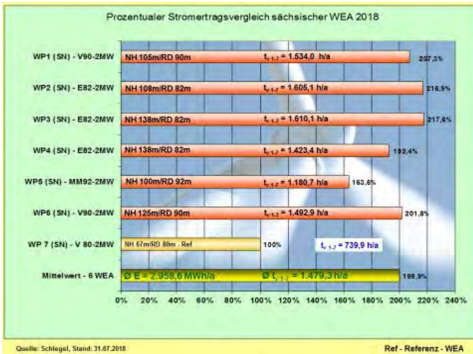
Abb. 32: Stromerträge-Vergleich - prozentual und nach Volllaststunden (Juli)
