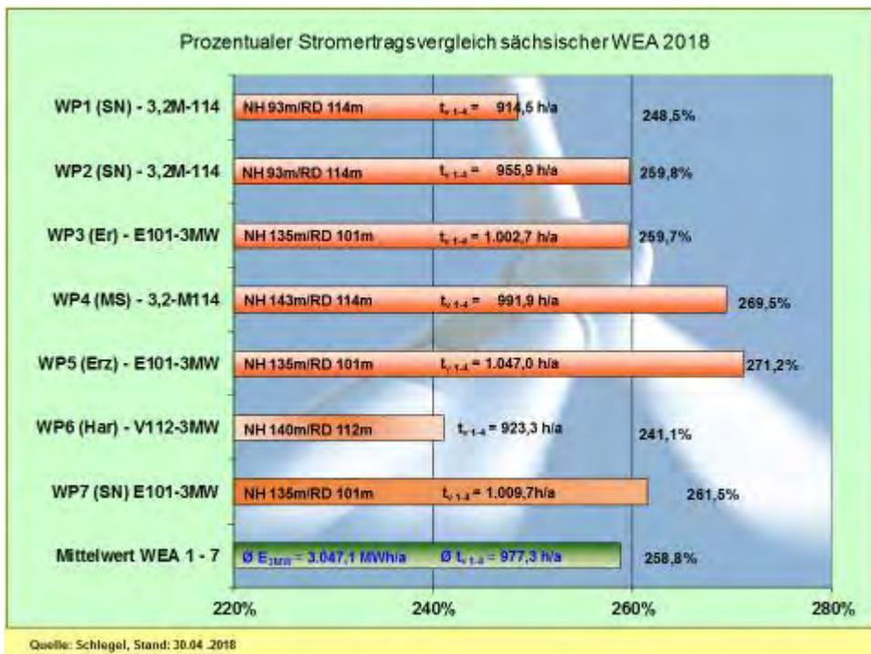
Abb. 31: Stromerträge-Vergleich 3MW-Klasse - prozentual und nach Vollaststunden (April)
