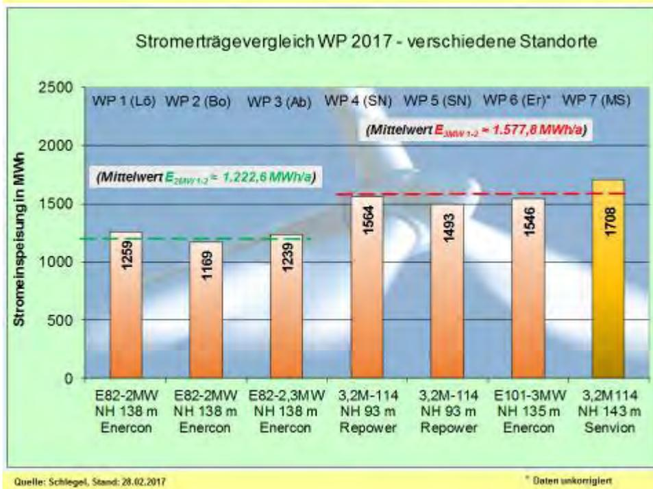
Abb. 51: Stromerträge-Vergleich von WEA im Sachsenquerschnitt (Februar)
