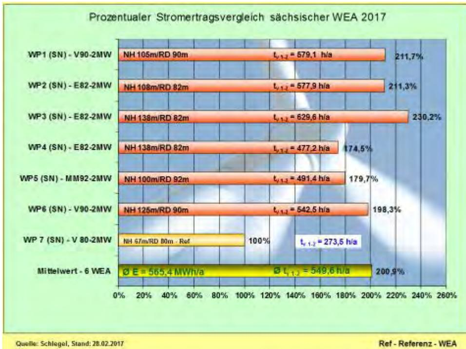
Abb. 48: Stromerträge-Vergleich - prozentual und nach Volllaststunden (Februar)
