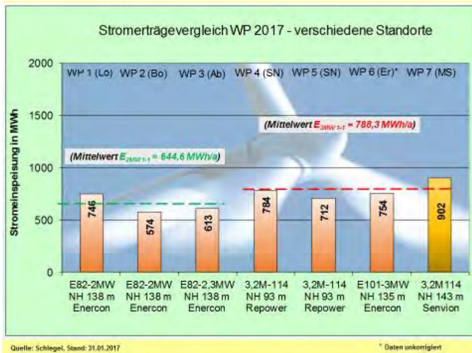
Abb. 35: Stromerträge-Vergleich – 2MW-Klasse mit 3MW-Klasse (Januar)
