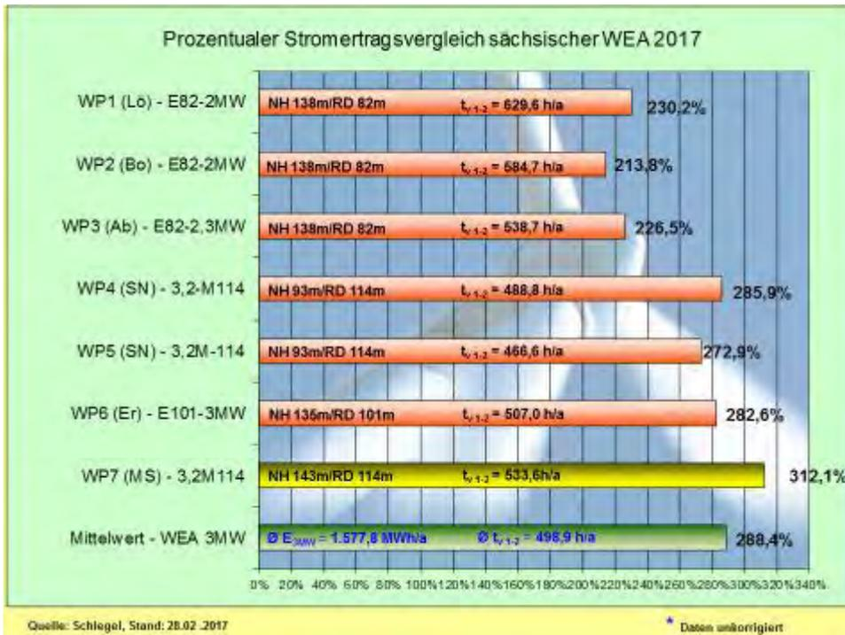
Abb. 52: Stromerträge-Vergleich - prozentual und nach Volllaststunden (Februar)
