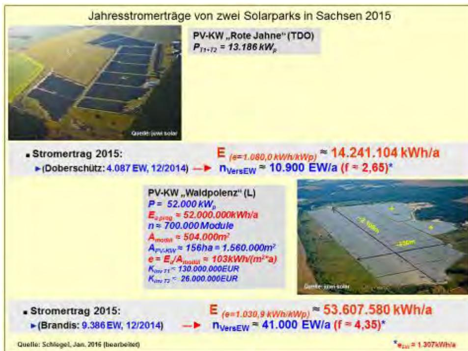
Abb. 12: Jahresstromerträge von zwei ausgewählten PV-Kraftwerken
